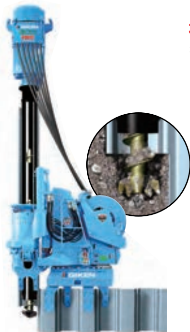
硬質地盤圧入時
