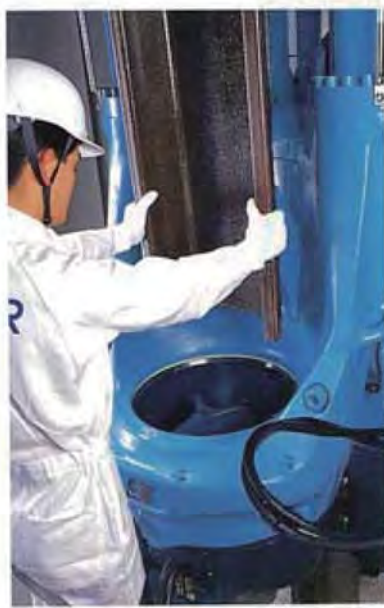
矢板の投入部位を低位置で設計し、同時に内部形状も一新。建て込み作業が楽に行え、作業能率が向上します。
