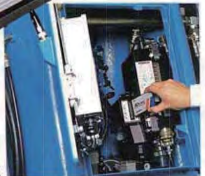
自動運転の心臓部。名刺大のICカードに施工ノウハウを集約しました。
